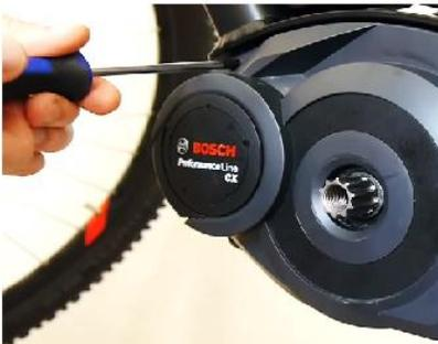
**2.** Die Gehäuseabdeckung entfernen, je nach Modell auch nur das Bodenblech oder eine kleine Abdeckplatte, um an den verbauten Sensorstecker Ihres Bikes zu gelangen.
