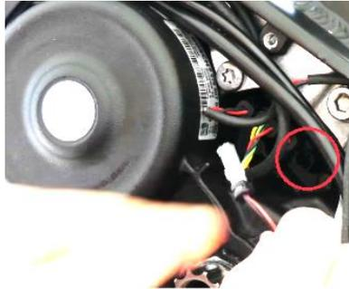
**Achtung: NIEMALS andere Kabel als die des Speedsensors mit dem BIKETEUFEL Tuningmodul verbinden! Zu hohe Spannungen (>5.5V DC) können das Modul beschädigen!**
