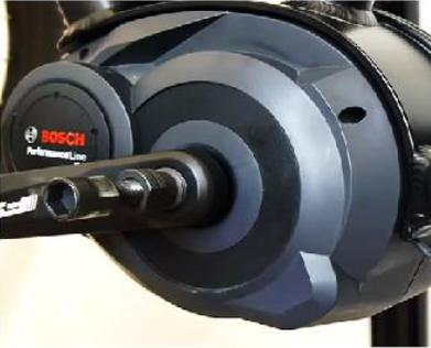
**1.** Bei manchen Modellen muss zum Öffnen der Motorabdeckung die Tretkurbel demontiert werden. Dafür benötigt man bei Bosch-Bikes unter anderem einen ISIS-Kurbelabzieher.
